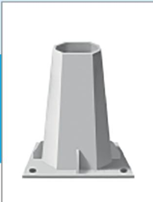
Опора граненая коническая представляет собой усеченную пирамиду. Поперечное сечение опоры имеет вид правильного восьмигранника. Опора освещения изготавливается из стального листового проката, методом гибки с продольным и поперечными сварными швами.
