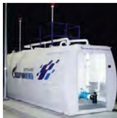
Все резервуары проходят проверку и дробеструйную камеру, а затем покрываются грунтом. Вся обшивка контейнера выполняется металлом не тоньше 3 мм, после чего проводится нанесение грунта и лакокрасочного покрытия. Общая толщина стенок КАЗС — 13 мм.
